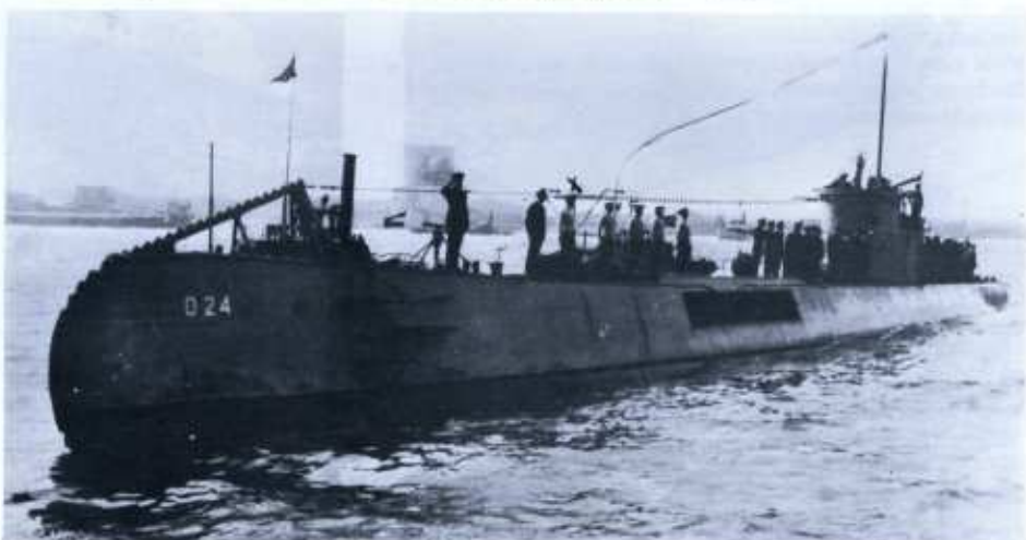
Op 7 mei 1946 keerde de bij de RDM gebouwde 'O 24', die op 12-5-1940 naar Engeland was uitgeweken en daar afgebouwd, naar Nederland-Rotterdam terug. Piet de Klerk staat onder het kruisje op de foto. Technische gegevens: waterversplaatsing boven water 962 ton, onder water 1.175 ton; wapening 1 kanon van 8.8 cm, 1 oerfikon van 20 mm, 8 torpedobuizen; snelheid 19/8 mijl.
